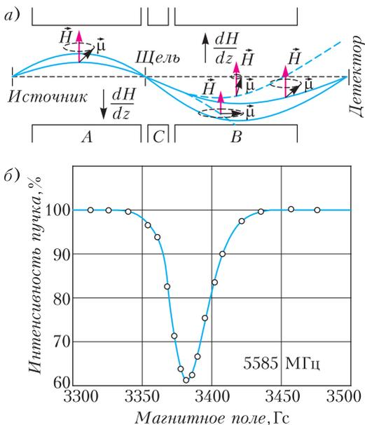
Рис. 5. Схема эксперимента Раби (а) и полученная им резонансная кривая (б). Здесь А и В – магниты, создающие неоднородное магнитное поле  $dH/dz$ ; С – магнит, создающий однородное магнитное поле  $\vec{H}$ , в котором частицы облучаются радиоизлучением и могут поглощать его и изменять ориентацию своего магнитного момента  $\vec{\mu}$ ; щель на выходе из первого магнита пропускает только частицы с нужными траекториями
