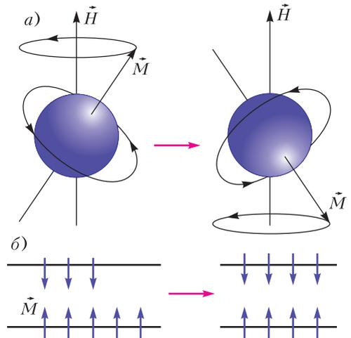
Рис. 4. Иллюстрация переходов между состояниями с разными ориентациями дипольного момента частицы  $\vec{M}$  относительно внешнего магнитного поля напряженности  $\vec{H}$  в терминах классической (а) и квантовой (б) физики. В обоих случаях переход обозначен красной стрелкой
