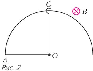
Вектор магнитной индукции перпендикулярен плоскости полукольца. Центр полукольца соединен с ним двумя проводниками, один на которых,  $AO$ , неподвижный, другой,  $OC$ , поворачивают вокруг точки  $O$  с угловой скоростью  $\omega = 10$  рад/с. Сопротивление единицы длины всех проводников  $\rho = 0,65$  Ом/м. Найдите ток в контуре  $AOC$  в момент, когда угол между  $AO$  и  $OC$  равен  $\pi$ .
